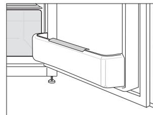
Tous les balconnets et les bacs peuvent être enlevés pour le nettoyage. Pour les extraire de la porte, tapoter avec le poing du bas vers le haut d'abord d'un côté puis de l'autre dans la zone d'introduction. Éviter d'enfiler dans le porte-bouteilles des bouteilles trop lourdes et de les laisser tomber sur le fond au moment de leur mise en place.
