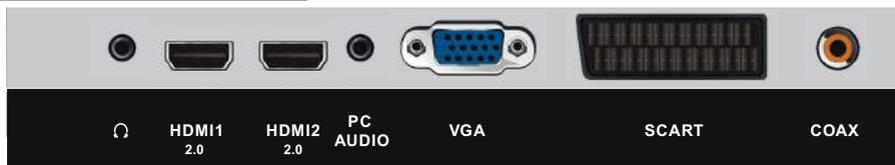
Utilisez un câble coaxial pour connecter un amplificateur audio ou autre appareil de décodage audio pour sortie audio coaxiale. (Le câble coaxial n'est pas fourni)
