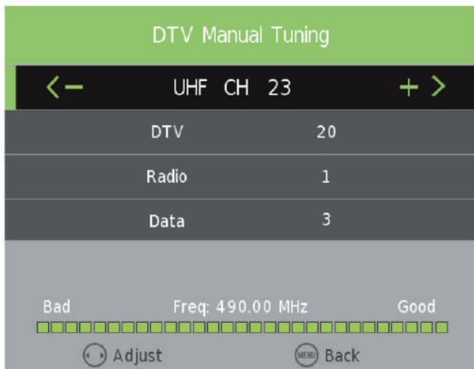
Appuyer sur les touches «Gauche»/« Droit» ◀ / ▶ pour régler les chaînes. Lorsqu'il y a un signal, appuyer sur OK pour commencer la recherche TNT.
