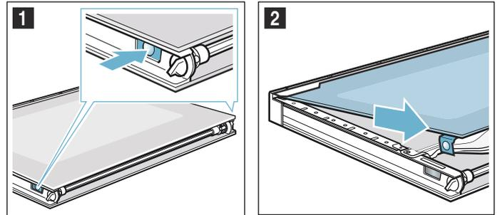
5. Appuyez vers le bas sur la vitre intermédiaire dans la zone a, soulevez avec précaution la fixation b, jusqu'à ce que vous puissiez la retirer (figure 3).
