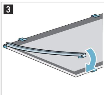
3. Placez la vitre intermédiaire avec les joints et les écarteurs. La flèche sur la vitre intermédiaire doit correspondre avec celle du cadre (figure **4**).
