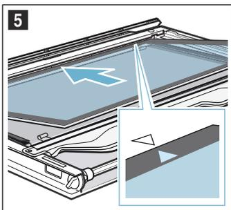
5. Appuyez vers le bas sur la vitre intermédiaire dans la zone **b**, insérez la fixation **c** en biais et appuyez jusqu'à ce qu'elle s'encliquette (figure **6**). La fixation est insérée (figure **7**).
