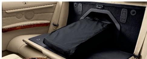
□ **Trappe à skis élargie avec sac de transport intégré**. Les dimensions de la trappe passent à 40 x 26 centimètres lorsque les dossiers des sièges arrière sont rabattus. Le sac de transport de longueur variable permet de transporter des objets longs sans devoir rabattre les dossiers des sièges arrière.
