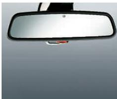
□ **Rétroviseur intérieur électrochrome**. Il s'assombrit progressivement en fonction de l'intensité des faisceaux lumineux qui s'y réfléchissent. Résultats : une visibilité optimale vers l'arrière et une meilleure concentration en conduite de nuit.
