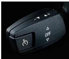
■ **Régulateur de vitesse**. À partir de 30 km/h environ, il mémorise et maintient la vitesse souhaitée (affichage sur l'écran d'information). Après une accélération, il rétablit automatiquement la vitesse enregistrée au préalable. Lorsque le conducteur freine, la fonction est désactivée. Les modèles six cylindres disposent en plus d'une fonction freinage.
