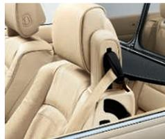
■ **Système de ceintures de sécurité intégrées aux sièges.** Il garantit une géométrie de sangle parfaite dans toutes les positions de réglage du siège pour une protection optimale. La ceinture est toujours bien plaquée contre le corps.
