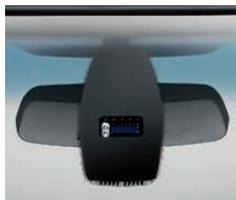
■ **Détecteur de pluie et allumage automatique des feux de croisement**. Une fois activé, le détecteur enclenche les essuie-glace dès les premières gouttes et commande la cadence du balayage en fonction de l'intensité de la pluie. La fonction intégrée d'allumage automatique des projecteurs actionne les feux de croisement au crépuscule ou au passage dans un tunnel.
