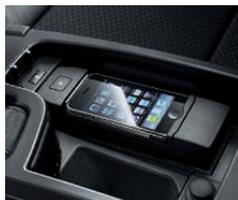
□ **Préparation et interface Bluetooth pour téléphone portable** et dispositif mains libres, connexion pour recharge et antenne extérieure. Un adaptateur fourni séparément permet de raccorder un téléphone Bluetooth<sup>2</sup> que l'on peut alors commander via iDrive (en combinaison avec le système de navigation).
