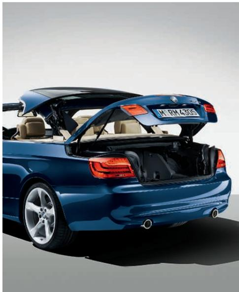
■ **Fonction de chargement/déchargement Confort** : elle facilite l'accès au coffre à bagages lorsque le toit rigide est ouvert. Une simple pression sur la clé radiocommandée suffit pour faire sortir partiellement le toit. Le couvercle du coffre s'ouvre et le conducteur n'a plus qu'à rabattre manuellement le cache rigide pour disposer d'une ouverture de chargement maximale. Avantage : il peut charger le coffre à bagages confortablement sans être obligé de refermer entièrement le toit.
