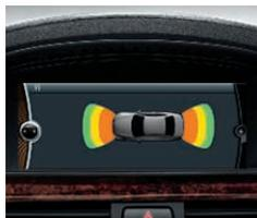
□ **Systèmes d'aide au stationnement PDC** : avant et arrière ou uniquement arrière (de série) ; il facilite les manœuvres dans un espace réduit. D'autre part, il indique que votre véhicule s'approche d'un obstacle par un signal acoustique (ou optique sur l'écran de contrôle en combinaison avec le système de navigation).
