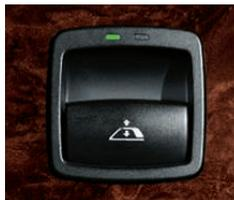
■ **Interrupteur central** permettant d'ouvrir et de fermer le toit rigide rétractable et les vitres latérales de manière entièrement automatique. Le toit s'ouvre en 22 secondes environ.
