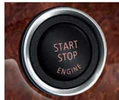
■ **Bouton de démarrage « Start/Stop »**. Il permet de démarrer la voiture ou d'arrêter le moteur par le biais de la clé radiocommandée, après avoir inséré cette dernière.
