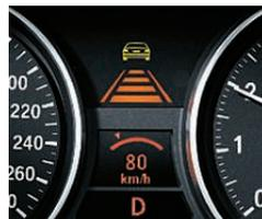
□ **Régulateur de vitesse actif ACC**. En cas de circulation en files ininterrompues, il adapte la vitesse de votre BMW à celle du véhicule qui précède et maintient automatiquement une distance de sécurité prédéfinie via un capteur radar. La fonction freinage garantit en outre que la vitesse reste constante même dans les descentes (non disponible sur les modèles quatre cylindres).
