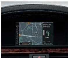
□ **Système de navigation Business**, avec lecteur CD, « Controller » iDrive avec touches d'accès direct et de raccourci, mémoire intégrée pour données de navigation, guidage par cartes ou affichage en simultané des flèches et d'une carte, et écran haute résolution de 6,5" (16,5 cm).
