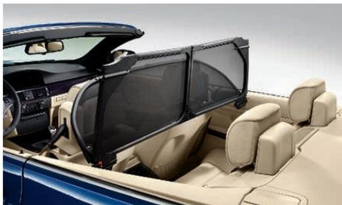
□ **Filet anti-remous** : il permet de conduire à ciel ouvert sans courants d'air ni tourbillons au niveau des épaules et de la nuque. Il peut être relevé en un tour de main pour faciliter le chargement et le déchargement. Plié, il se range dans une housse, dans le coffre à bagages.
