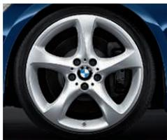
□ **Jantes en alliage léger 19" (48 cm) style 230 à rayons en étoile**, avec monte pneumatique mixte. Dimensions : 8 J x 19 à l'avant, pneumatiques 225/35 R 19 ; 9 J x 19 à l'arrière, pneumatiques 255/30 R 19.
