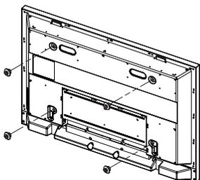
4 Retirez la goupille de sécurité (③), puis insérez les 4 supports du produit dans les trous correspondants sur la fixation (①). Placez ensuite le produit (②) en veillant à ce qu'il soit solidement attaché à la fixation. Veillez à réinsérer et à serrer la goupille de sécurité (③) pour fixer solidement le produit au support.
