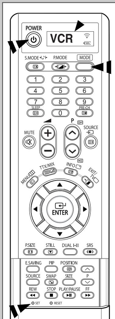
*Votre téléviseur est livré avec une télécommande universelle. La télécommande universelle permet de piloter non seulement le téléviseur, mais également un magnétoscope, une boîte de jonction, un lecteur DVD et certains boîtiers décodeurs Samsung (même si votre magnétoscope, votre boîte de jonction et votre lecteur DVD ont été fabriqués par des constructeurs autres que Samsung).*
