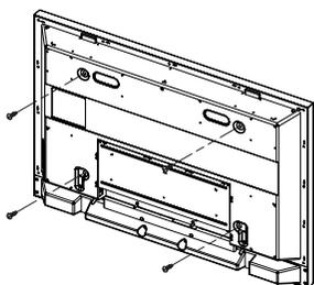
2 Insérez la vis ⑥ dans la suspension en plastique. (Voir la figure ci-dessous.)
