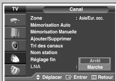
*Cette fonction se révèle particulièrement utile si le signal TV est faible. La fonction LNA (amplificateur à faible bruit) amplifie le signal TV dans une zone où il est faible. Un préamplificateur à faible bruit augmente le signal d'arrivée.*
