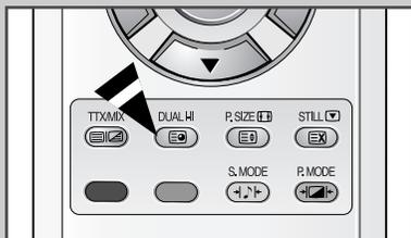
Le bouton "DUAL I-II" affiche/commande le traitement et la sortie du signal audio. A la mise sous tension, le mode est pré réglé automatiquement sur "Dual-I" (Double-I) ou "Stéréo" (Stéréo) en fonction de la transmission en cours.
