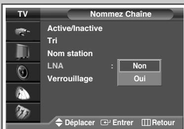
*Cette fonction s'avère particulièrement utile si le signal télévisuel est faible. La fonction LNA amplifie le signal TV dans la zone de signal faible sans pour autant augmenter le bruit.*
