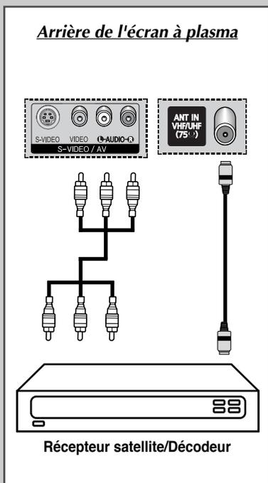
*Afin de regarder des programmes de télévision via un réseau satellite, vous devez brancher un récepteur satellite à l'arrière de l'écran à plasma. Afin de décrypter un signal de transmission codé, vous devez brancher un décodeur à l'arrière de l'écran à plasma.*
