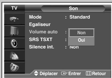
*Chaque station d'émission possède ses propres conditions de signal et il n'est donc pas facile de régler le volume chaque fois que vous changez de canal. Cette fonction vous permet de régler automatiquement le volume du canal désiré en réduisant la puissance sonore lorsque le signal de modulation est élevé ou en augmentant la puissance sonore lorsque le signal de modulation est faible.*
