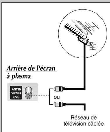
*Afin de retransmettre correctement les canaux de télévision, le téléviseur doit percevoir un signal depuis l'une des sources suivantes:*
