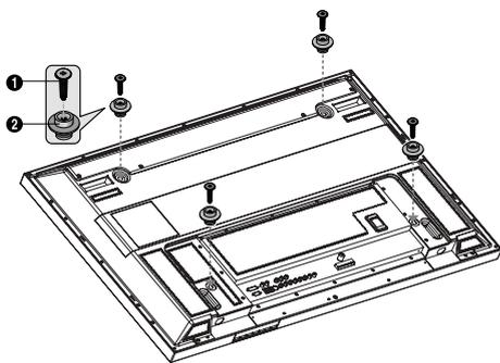
4 Insérez les 4 pièces isolantes de l'écran dans les rainures du support de fixation murale et abaissez l'écran (1) pour le fixer sur le support (2). Serrez la vis de la façon indiquée (3) afin que l'écran ne puisse se détacher de son support.
