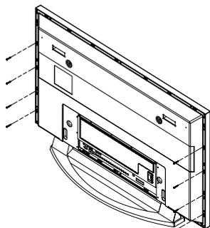
2 Placez les deux crochets en "T" dans les orifices carrés à l'arrière de l'écran à plasma.
