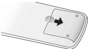
**2** Insérez deux piles AAA. Veillez à ce que les bornes + et - des piles correspondent à celles du schéma qui figure à l'intérieur du compartiment.
