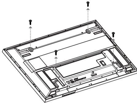
2 Installez les pièces isolantes sur les vis (voir l'illustration ci-dessous).
