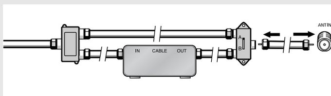
Une fois les branchements terminés, choisissez la position "A" du commutateur A/B pour les chaînes standard. Choisissez la position "B" du commutateur A/B pour regarder les chaînes brouillées. (Quand vous choisissez la position "B" du commutateur A/B, vous devez aussi syntoniser la chaîne du signal de sortie du câblodistributeur, habituellement la chaîne 3 ou 4.)
