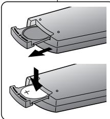
**FRANÇAIS****Prise en main****Insertion de la pile au lithium (SC-D457 uniquement)****Insertion de la pile de la télécommande**
