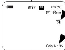
**Enregistrement simple****Utilisation de la fonction Color Nite/Diode lumineuse (modèles SC-D455/D457 uniquement)**
