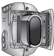
[ Insertion de la pile de type CR-V3 ]
