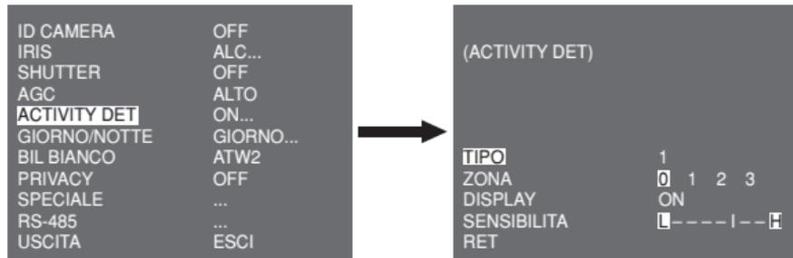
Esistono 3 diversi tipi di configurazione: Tipo 1, 2 e 3. Non si può cambiare l'impostazione per tipo 2 perchè è già preimpostato a schermo intero. Nel caso di 1 e 3 si può impostare l'area di rilevamento movimento.
