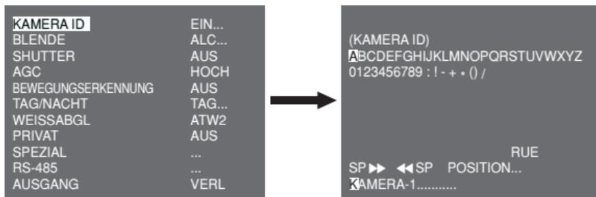
Sie können eine Kamera ID bestehend aus Buchstaben, Zahlen und Sonderzeichen mit bis zu 20 Zeichen eingeben. Die Eingabe der Kamera ID kann an der gewünschten Position angezeigt werden, wenn Sie das Untermenü POSITION... verwenden. Wenn Sie den Schalter **Einstellung** unter **RUE** drücken, kehrt der Bildschirm zum oberen Menü zurück.
