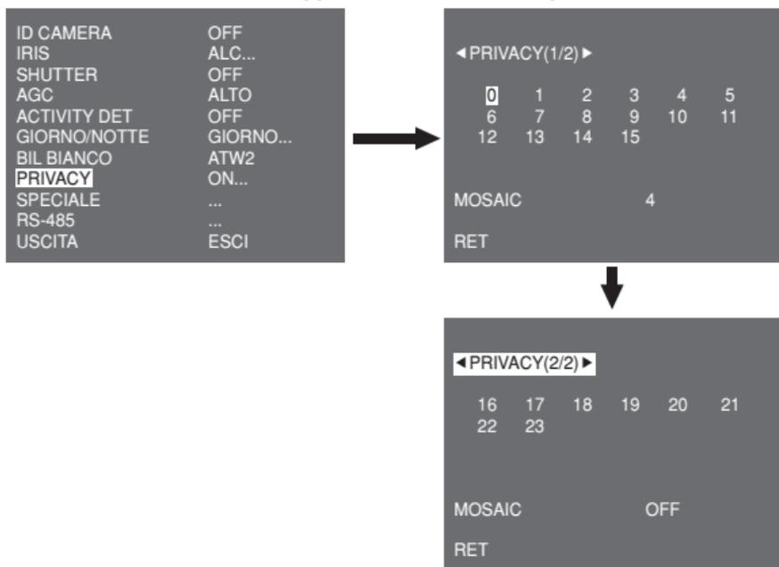
Si possono impostare 24 zone di privacy in totale. Per la configurazione delle zone da 0 a 15, occorrerà impostare le dimensioni, la posizione e il colore. In caso di configurazione delle zone da 15 a 23 occorre impostare anche il tipo.
