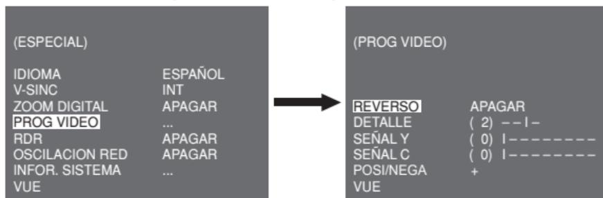
Puede configurar los valores para REVERSO, DETALLE, SEÑAL Y, C-NIVEL y POSI/NEGA.
