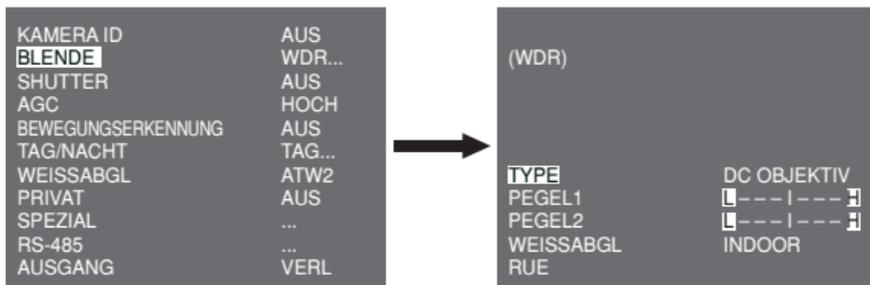
Wählen Sie zunächst entweder das DC OBJEKTIV, VIDEO OBJEKTIV oder MANU unter **TYPE** Sie können die Verschluss geschwindigkeit unter **PEGEL 1** und die Helligkeit unter **PEGEL 2** einstellen. Sie können ebenfalls zwischen ALLE, EXTERN und INDOOR unter **WEISSABGL** auswählen. Im Falle von ALLE, steuert diese Kamera sowohl INDOOR als auch externe Bilder.
