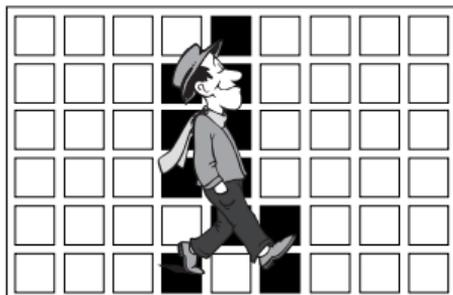
Per impostare l'area di rilevamento movimento, si dovranno specificare le dimensioni e la posizione per l'impostazione dell'area. Quando viene selezionato ON in **DISPLAY**, il movimento rilevato è visualizzato sullo schermo e la telecamera invia il segnale uscita Allarme. È possibile anche assegnare la sensibilità per la rilevazione movimento.
