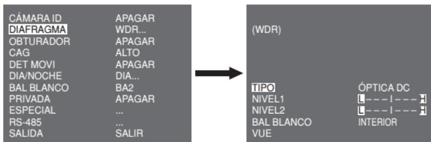
Primero seleccione cualquier ÓPTICA DC, ÓPTICA VÍDEO o MANU en **TIPO**. Puede ajustar la velocidad del obturador en **NIVEL 1**, y el brillo en **NIVEL 2**. También puede seleccionar TODO, EXTERIOR o INTERIOR en **BAL BLANCO**. En caso de seleccionar TODO, esta cámara controla las imágenes INTERIOR y exteriores.
