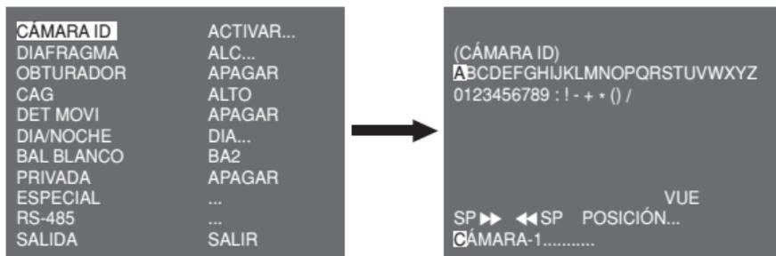
Puede introducir un identificador compuesto por letras, números y caracteres especiales hasta un total de 20 caracteres. El identificador de entrada puede aparecer en el lugar deseado cuando utilice el submenú de POSICIÓN...
