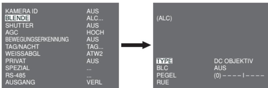
Sie können die BLC (Gegenlichtausgleich) Funktion aktivieren oder nicht. Wählen Sie für die Einstellung der BLC Zone zwischen OBEN..., UNTEN..., LINKS..., RECHTS... und MITTE... Die gegenwärtige Position wird angezeigt, sobald Sie das jeweilige Element eingeben.
