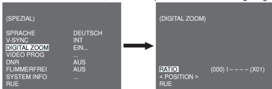
Die erste angezeigte Zahl steht für Zoom verhältnis und die zweite angezeigte Zahl ist die Verstärkung. Wenn der Pegel 130 erreicht, wird die Verstärkung 2. Nach Auswahl der Zoomposition, findet die digitale Zoomfunktion Anwendung.
