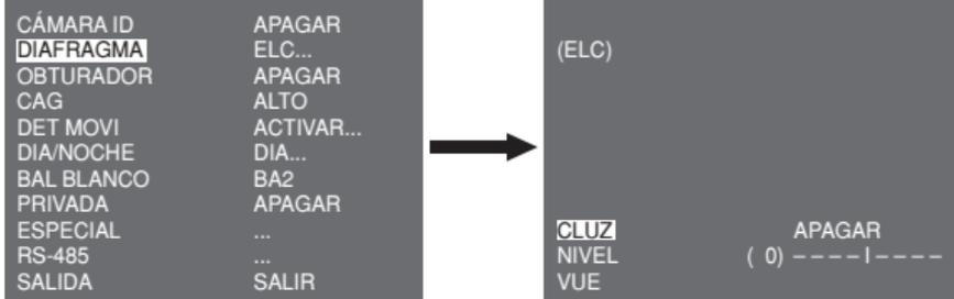
Al igual que con la configuración de ALC, puede configurar la zona CLUZ y determinar el nivel del obturador de alta velocidad.
