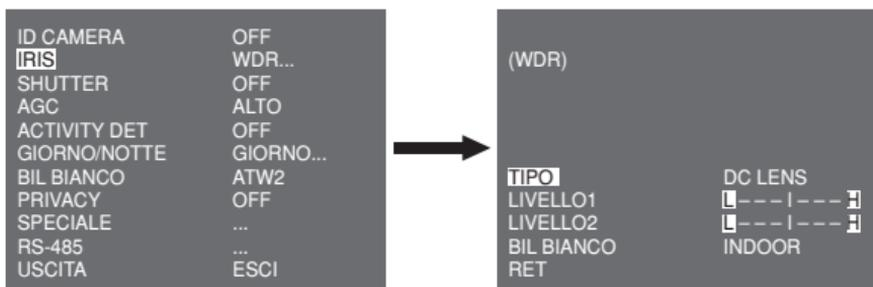
Per prima cosa selezionare OBIETTIVO DC, OBIETTIVO VIDEO o MANU in **TIPO**. È possibile regolare la velocità dell'otturatore in **LIVELLO 1** e la luminosità in **LIVELLO 2**. È inoltre possibile selezionare TUTTI, ESTERNO e INDOOR in **BIL BIANCO**. In caso di TUTTI, la telecamera controlla sia immagini esterne sia INDOOR.
