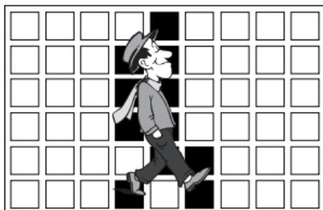
Pour régler la zone de détection de mouvements à votre convenance, vous devez spécifier la taille et la position pour le réglage de la zone. Lorsque ON est sélectionné dans **DISPLAY**, le mouvement détecté s'affiche sur l'écran et la caméra envoie le signal de sortie d'alarme. Vous pouvez également choisir la sensibilité pour la détection de mouvements.
