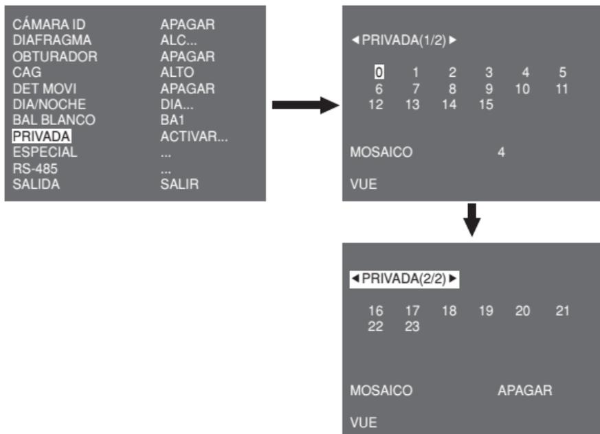
Puede configurar 24 zonas de privacidad en total. Para configurar de 0 a 15 zonas, tiene que determinar el tamaño, localización y color. En caso de configurar de 15 a 23 zonas, tiene que configurar además el tipo.
