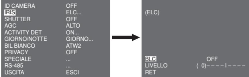
Come per la configurazione ALC è possibile impostare la zona BLC e assegnare il livello dell'otturatore ad alta velocità.
