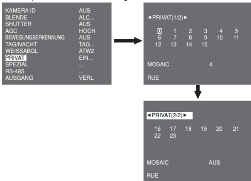
Sie können insgesamt 24 Privatzonen einstellen. Für die Konfiguration für die Zonen 0 bis 15, müssen Sie die Größe, Position und Farbe einstellen. Im Falle der Konfiguration für Zonen 15 bis 23, müssen Sie zusätzlich den Typ einstellen.
