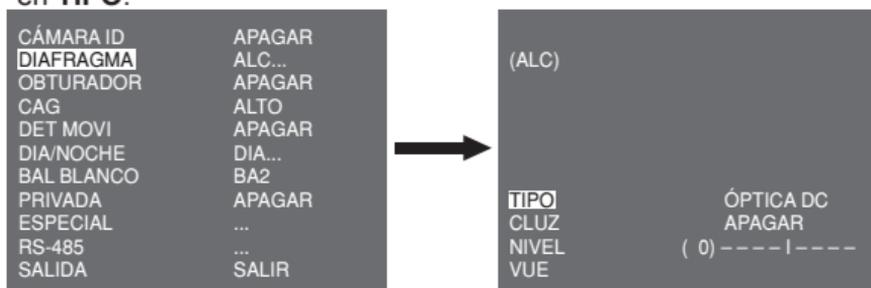
Puede activar o desactivar la función CLUZ (Compensación de luz posterior). Para configurar la zona CLUZ, puede seleccionar ARRIBA..., ABAJO..., IZQUIERDA..., DERECHA... Y CENTRO... La situación actual se muestra cuando entra en cada elemento. En caso de UTIL..., puede configurar la zona CLUZ deseada definiendo el tamaño y la posición. Puede configurar el nivel de salida de Vídeo en **NIVEL**. Puede escoger entre -9 y +9.
