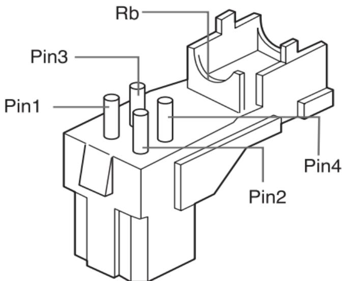
Conecte cada cable de control del obturador descubierto al conector de la lente iris automática siguiendo estos pasos:
