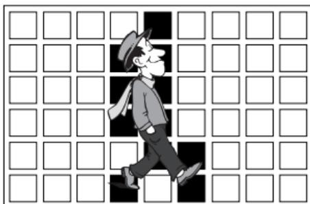
Para configurar por sí sólo el área de detección de movimiento, tiene que especificar el tamaño y localización para el área. Cuando esté seleccionado ACTIVAR en **DISPLAY**, aparece en pantalla el movimiento detectado, y la cámara envía la señal de Salida Alarma. También puede determinar la sensibilidad para la detección de movimiento.
