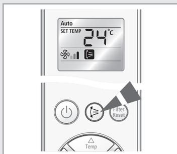
**La direction du débit d'air peut être réglée vers le haut et vers le bas. Cette fonction permet d'envoyer de l'air froid dans tous les recoins de la pièce.**
