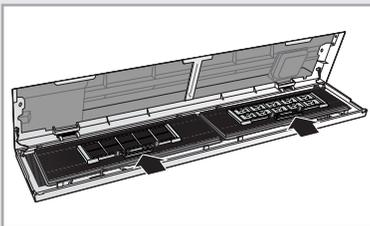
*Le climatiseur peut être équipé du filtre bio-pur ou déodorant pour enlever des particules minuscules. Bien que cela dépende de l'utilisation du climatiseur, le filtre doit être généralement changé tous les 3 mois.*
