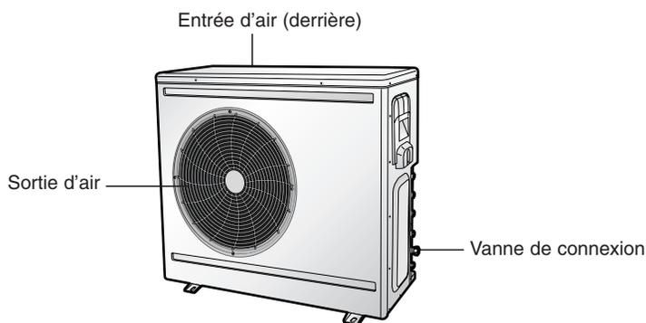
**Note** Si l'échangeur de la chaleur dans l'unité extérieure devient poussiéreux, l'efficacité de refroidissement pourrait diminuer. Nettoyer donc l'échangeur à l'eau quand il devient sale. Toutefois, faites attention quand vous nettoyez la surface de l'appareil, car il est très tranchant.
