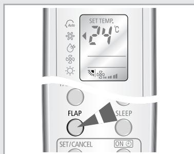
***Vous pouvez ajuster verticalement la direction du souffle d'air. Les pales extérieures du climatiseur s'orientent vers le haut ou vers le bas afin d'optimiser de réfrigération ou de chauffage.***
