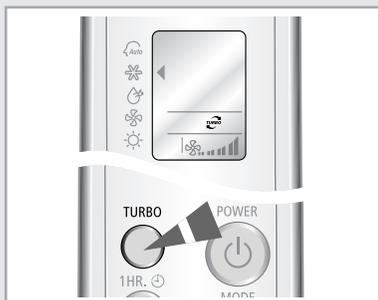
**Sélectionnez la fonction Turbo si vous souhaitez réfrigérer ou chauffer votre pièce le plus rapidement possible. Le climatiseur retourne en mode précédent au bout de 30 minutes de fonctionnement à sa capacité maximale.**
