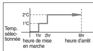
**Chauffage** La température baisse de 1°C par heure. Lorsqu'elle baisse de 2°C (après deux heures), la nouvelle température est maintenue pendant quatre heures.
