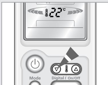
3 Pour régler la température, appuyez sur le bouton
