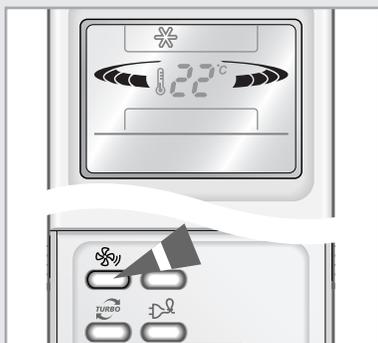
4 Sélectionner la vitesse de ventilation en appuyant sur le bouton
