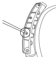
12. Retirez les deux vis maintenant le châssis avant sur la gauche.
