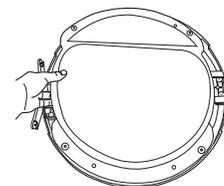
7. Montez le support du hublot dans le sens indiqué. (Après le désassemblage, remontez-le en le faisant pivoter de 180°.)
