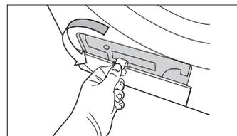
2. Déverrouillez la fixation du condensateur.
