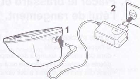
Pour débrancher le transformateur de courant alternatif, le déconnecter d'abord de la prise électrique, puis retirer la fiche du transformateur de courant alternatif de l'unité principale.
