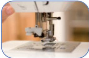
Le système d'enfilage avancé de l'**Innov-ís 600** vous permet d'enfiler le fil dans le chas de l'aiguille en une seule opération, sans effort.
