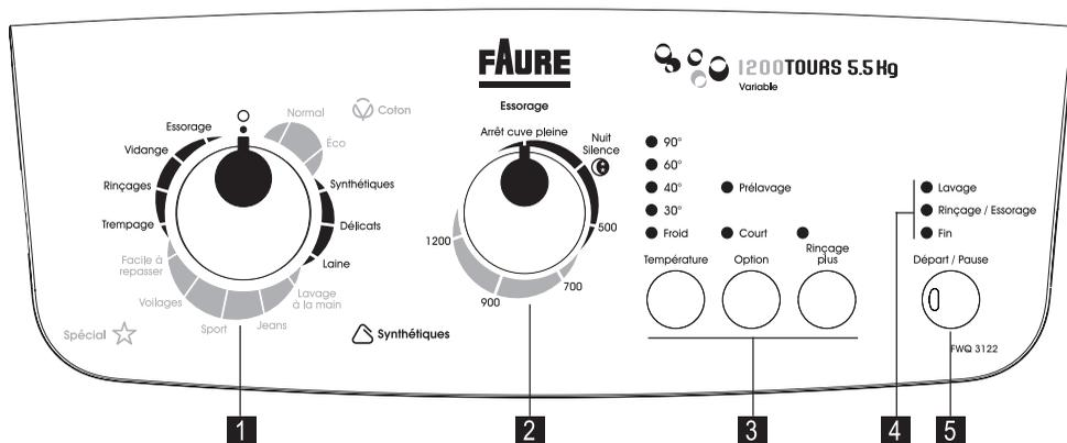
1. **Sélecteur de programmes** : Sur la position
