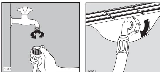
Si le branchement se fait sur des tuyauteries neuves ou qui n'ont pas servi depuis longtemps, il est préférable de faire couler une certaine quantité d'eau avant de mettre en place le tuyau de remplissage. De cette façon, on évitera que du sable ou de la rouille bouche le filtre placé à l'intérieur de l'appareil.
