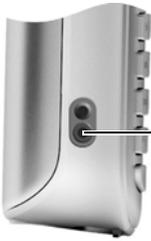
Une fois le couvercle en plastique retiré, vous pouvez raccorder un kit oreillette (notamment des kits piéton HAMA et Plantronics M40, MX100 et MX150) sur le côté gauche de votre téléphone à l'aide d'une prise de 2,5 mm.
