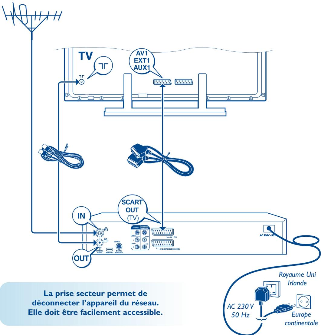
**La prise secteur permet de déconnecter l'appareil du réseau. Elle doit être facilement accessible.**
