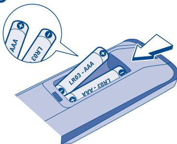
2- Installez deux piles AAA (LR03) en veillant à les mettre dans le bon sens. Le dessin au fond du compartiment précise le sens des piles. Le pôle négatif (-) vers le ressort.
