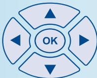
Les touches de navigation permettent de choisir et de valider des fonctions dans les menus. Le sens des flèches indique les sens de déplacement dans les menus.
