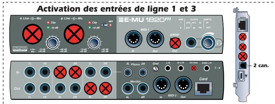
Au taux d'échantillonnage de 192 kHz, vous sacrifiez S/PDIF, l'entrée de ligne 3 et la sortie de ligne 3. Optique ADAT est réduit à deux canaux. Vous pouvez choisir l'une des options suivantes :
