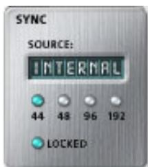
Les Indicateurs de synchronisation/taux d'échantillonnage affichent le taux d'échantillonnage en cours de la session actuelle et indique s'il est interne ou subordonné à une source externe. Les DEL indiquent quel taux d'échantillonnage est actuellement appliqué. Si une source externe est utilisée, l'affichage Source montre « EXTERNAL ».
