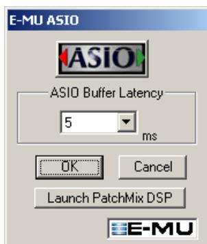
Le temps d'attente tampon ASIO doit être réglé sur 5 millisecondes ou moins, en fonction de la vitesse de l'unité centrale de votre ordinateur. Cette commande permet d'ajuster le délai qui se produit lors du transfert de données audio entre le matériel du système audio numérique et Cubase.
