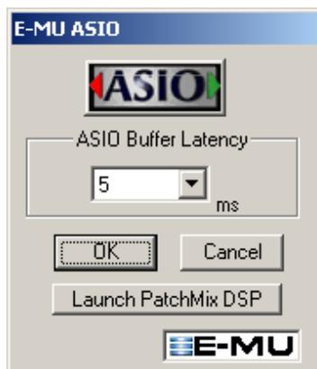
Le temps d'attente tampon ASIO doit être réglé sur 5 millisecondes ou moins, en fonction de la vitesse de l'unité centrale de votre ordinateur. Cette commande permet d'ajuster le délai qui se produit lors du transfert de données audio entre le matériel du système audio numérique et Cubasis.
