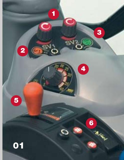
Mémoires de vitesses SV1/SV2 (1), modes de fonctionnement « Pédale » ou « Levier » (2) et sélection de la gamme (3), le tout regroupé en une seule et même commande. Le « Superviseur » (4) fonctionne en permanence au second plan pour vous aider à optimiser la productivité. Levier de commande de la vitesse (5) et boutons d'activation des vitesses SV1/SV2 (6) montés de façon ergonomique sur l'accoudoir réglable
