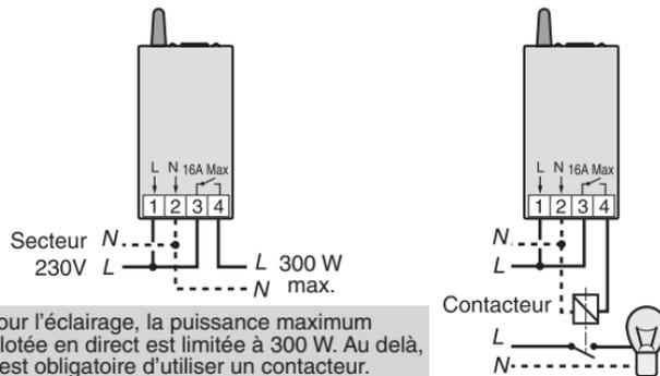
Pour l'éclairage, la puissance maximum pilotée en direct est limitée à 300 W. Au delà, il est obligatoire d'utiliser un contacteur.
