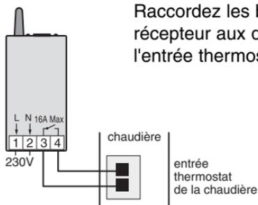
Si nécessaire, supprimez le shunt (fil électrique) reliant les deux bornes de l'entrée thermostat.
