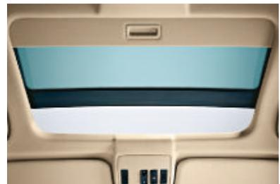
□ **Toit ouvrant en verre coulissant et entrebâillable électriquement** par touches à impulsions, protection anti-pincement et ouverture/fermeture confort.
