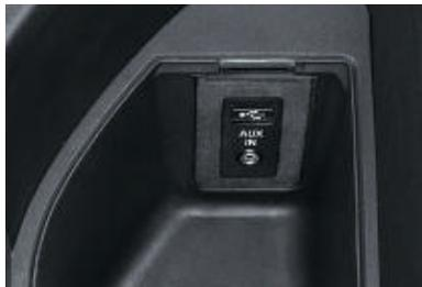
□ **L'interface audio USB** permet de raccorder un iPod, un lecteur MP3 ou une clé USB et d'écouter les fichiers audio qu'ils contiennent. Commande et lecture via le « Controller », les touches de raccourci, les touches sur le volant et le système audio équipant la voiture.
