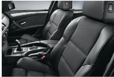
□ **Sièges avant Sport.** Leurs flancs proéminents assurent un maintien latéral optimal dans toutes les situations de conduite. Avec réglage électrique de la hauteur de l'assise et de l'inclinaison du dossier et réglage manuel de l'inclinaison de l'assise, de la position longitudinale et de la longueur de l'assise.
