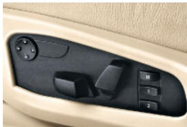
□ **Sièges avant électriques** sur tous les axes, avec mémoires pour le siège conducteur, les rétroviseurs extérieurs et la colonne de direction, et basculement automatique du rétroviseur extérieur côté passager au passage de la marche arrière. De série sur les BMW 540i et 550i.
