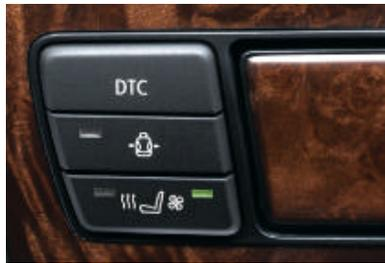
□ Les **sièges avant à ventilation active** assurent une température rafraîchissante en été et augmentent nettement le confort. Des ventilateurs dans l'assise et dans le dossier soufflent de l'air à travers le garnissage perforé.
