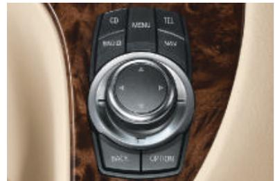
■ Le « **Controller** » est une molette-poussoir permettant d'accéder intuitivement à différentes fonctions qui s'affichent sur l'écran de contrôle. Les quatre menus CD, autoradio, navigation et téléphone sont par ailleurs accessibles via des touches d'accès direct. Les trois touches Menu, Option et Back (précédent) facilitent encore la manipulation.
