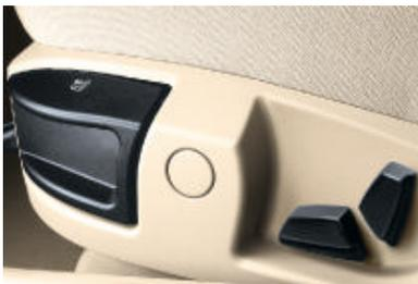
■ **Sièges avant partiellement électriques,** réglage électrique de la hauteur de l'assise et de l'inclinaison du dossier, réglage manuel de la position longitudinale et de l'inclinaison de l'assise côté conducteur.
