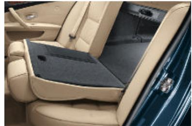
□ **Trappe à skis** avec banquette arrière rabattable en deux parties asymétriques. Le **sac à skis** contenu dans la trappe permet de transporter jusqu'à quatre paires de skis sans salir l'habitacle et en laissant suffisamment de place pour quatre personnes. Non utilisé, le sac se range dans une cassette interchangeable peu encombrante.
