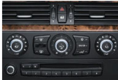
□ **Climatisation automatique bi-zone à fonctionnalités étendues** avec recyclage automatique de l'air, capteurs solaire et de buée, réglage séparé conducteur/passager de la température à l'avant et réglage automatique du débit d'air. L'affichage et les réglages se font par le biais de l'écran de contrôle. De série sur les BMW 540i et BMW 550i.
