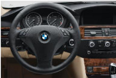
■ **Volant gainé cuir**, diamètre 385 mm, à trois branches et touches multifonctions intégrées permettant de commander l'autoradio, le lecteur de CD et le téléphone (option) tout en gardant les mains sur le volant. Avec deux touches librement programmables.
