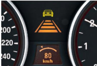
□ **Régulateur de vitesse actif ACC +.** Système d'aide à la conduite spécialement conçu pour un confort et une sécurité active accrus en circulation en files ininterrompues. Il combine les fonctions de régulateur de vitesse – avec maintien actif d'une distance de sécurité par rapport au véhicule qui précède – et de freinage jusqu'à l'arrêt complet avec redémarrage automatique.
