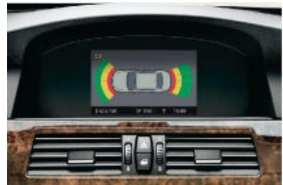
□ **Système d'aide au stationnement PDC avant et arrière**. Il facilite les manœuvres de stationnement sur les emplacements les plus étroits, la distance entre votre véhicule et un obstacle étant indiquée par un signal sonore et représentée sur l'écran de contrôle (de série sur BMW 540i et BMW 550i).
