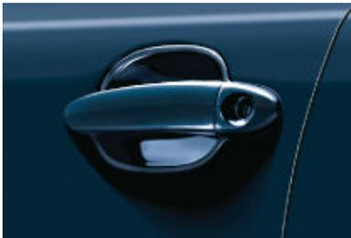
□ La **fermeture assistée des portes Soft Close** à moteur électrique ferme en douceur les quatre portes lorsque leur ouverture n'est plus que de six millimètres.
