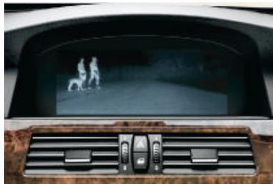
□ **Le système de vision nocturne « Night Vision »** retransmet sur l'écran de contrôle, à l'aide d'une caméra thermique, les images de personnes ou d'animaux se trouvant à une distance maximale de 300 mètres. Ainsi, sur les routes où la visibilité est insuffisante, vous pouvez apercevoir également les obstacles se trouvant en dehors du faisceau lumineux des projecteurs et anticiper les dangers.
