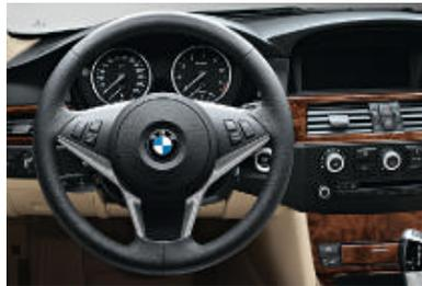
□ **Volant Sport gainé cuir**, à trois branches, avec touches multifonctions, pour une prise en mains parfaite grâce à son petit diamètre (379 mm). Les touches intégrées permettent de commander l'autoradio, le lecteur de CD et le téléphone (option) en cours de route. Avec deux touches librement programmables (de série sur BMW 540i et BMW 550i).
