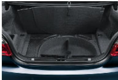
■ **Espace de rangement** sous le plancher plat du coffre à bagages, augmentant la capacité de chargement (en combinaison avec pneumatiques RSC permettant le roulage à plat). Les éléments de séparation représentés sur la photo font partie des Accessoires d'Origine BMW.
