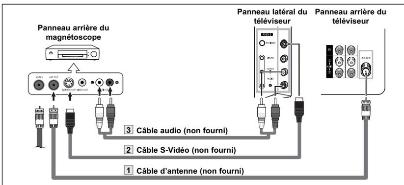
Un câble S-Vidéo est habituellement fourni avec un magnétoscope S-VHS. (Sinon, obtenez les câbles requis dans une boutique d'électronique.)
