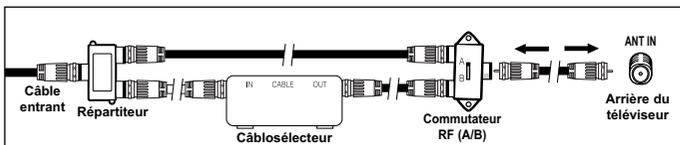
6. Reliez au moyen du dernier câble d'antenne la borne de sortie du commutateur RF (A/B) et la borne ANT IN à l'arrière du téléviseur.
