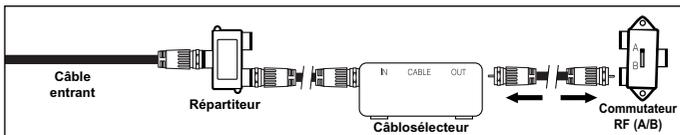
4. Reliez au moyen d'un câble d'antenne la borne de sortie d'antenne du câblodistributeur et la borne d'entrée B-IN du commutateur RF (A/B).
