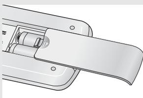
◀ Faites attention que les pôles “+” et “-” des piles soient bien alignés avec les marques à l’intérieur du compartiment.
