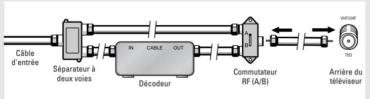
Une fois les branchements terminés, choisissez la position A du commutateur A/B pour les canaux standard et la position B pour les canaux brouillés. (Lorsque le commutateur A/B est en position B, vous devez syntoniser le canal de sortie du câblosélecteur, qui est habituellement le canal 3 ou 4.)
