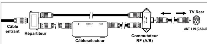
6. Reliez au moyen du dernier câble d'antenne la borne de sortie du commutateur RF (A/B) et la borne ANT 1 IN (CABLE) à l'arrière du téléviseur.
