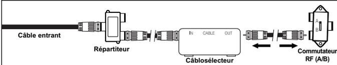
4. Reliez au moyen d'un câble d'antenne la borne de sortie d'antenne du câblosélecteur et la borne d'entrée B-IN du commutateur RF (A/B).
