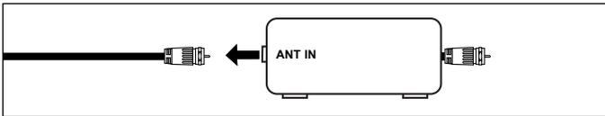
1. Repérez et débranchez le câble qui est raccordé à la borne d'entrée d'antenne de votre câblosélecteur.
