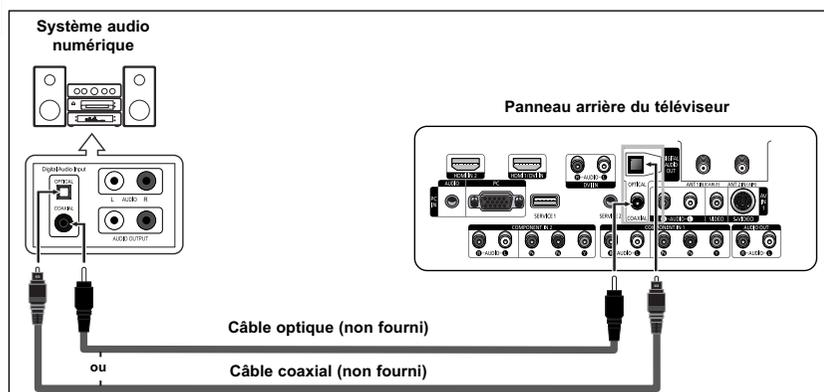
1. Branchez un câble optique ou coaxial entre les prises DIGITAL AUDIO OUT (OPTICAL ou COAXIAL) (Sortie audio numérique/Optique ou coaxiale) du téléviseur et les prises d'entrée numérique du système audio numérique.
