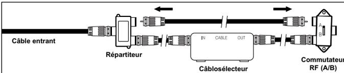
5. Reliez au moyen d'un autre câble l'autre borne de sortie du répartiteur et la borne d'entrée A-IN du commutateur RF (A/B).
