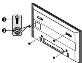
4 Insérez les 4 chevilles de l'écran à plasma dans les logements correspondants du support pour montage mural et tirez l'écran vers le bas (1) pour le fixer sur le support (2). Serrez les vis comme le montre la figure (3) de manière à ce que l'écran à plasma ne puisse pas être retiré du support de montage mural.
