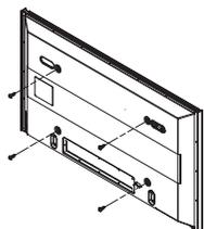
2 Utilisez les vis pour assembler le dispositif de fixation en plastique.
