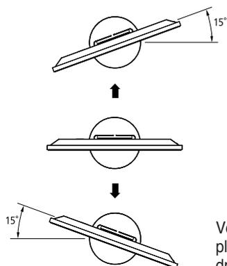
Vous pouvez régler l'angle de l'écran à plasma jusqu'à 15 degrés à gauche/à droite.
