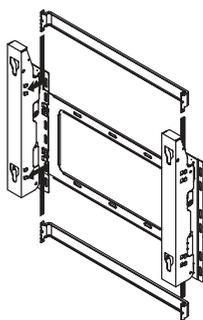
La fixation pour montage mural est fournie séparément. Serrez la vis imperdable dans le sens de la flèche après avoir assemblé la fixation.
