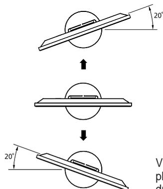
Vous pouvez régler l'angle de l'écran à plasma jusqu'à 20 degrés à gauche/à droite.
