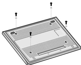
2 Utilisez les vis pour assembler le dispositif de fixation en plastique.
