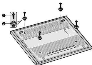
4 Insérez les 4 chevilles de l'écran à plasma dans les logements correspondants du support pour montage mural et tirez l'écran vers le bas (1) pour le fixer sur le support (2). Serrez les vis comme le montre la figure (3) de manière à ce que l'écran à plasma ne puisse pas être retiré du support de montage mural.
