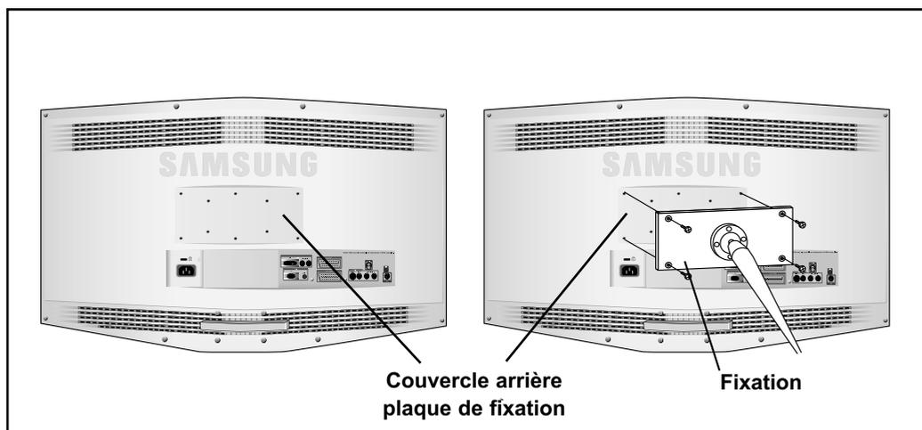
Alignez la plaque de l'interface de montage avec les trous de la plaque de fixation du couvercle arrière et bloquez-la à l'aide des quatre vis fournies avec la base type bras, avec le dispositif de fixation au mur ou avec les autres bases.
