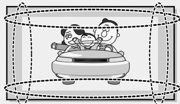
Bien que les programmes numériques doivent être diffusés en format HD Écran large (16:9), il arrive que les radiotélévisions diffusent des programmes initialement enregistrés en format normal (4:3) en convertissant les signaux en signaux numériques. Dans ce cas, les bords gauche et droit sont rognés.
