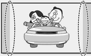
Bien que les programmes numériques doivent être diffusés en format HD Écran large (16:9), il arrive que les radiotélévisions diffusent des programmes initialement enregistrés en format normal (4:3) en convertissant les signaux en signaux numériques. Dans ce cas, les bords gauche et droit sont rognés.
