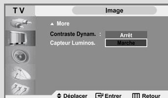
**Contraste Dynam.** est utilisé pour détecter automatiquement la distribution du signal visuel entrant ainsi que pour l'ajuster et créer ainsi un contraste optimum.
