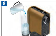
Napełnić zbiornik na wodę zużytym roztworem odwpariacza zgromadzonym w pojemniku i naciśnacj dowolny przycisk, aby powtórzyć procedurę.
