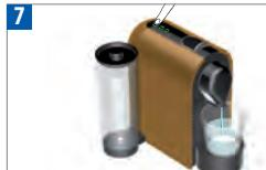
Pokud je posuvník zavřený, stiskněte kterékoli tlačítka a spusťte tak proces odvápnění. Pokud je posuvník otevřený, zavřete jej a spusťte tak proces odvápnění. Přístroj se vypne, až se nádoba na vodu vyprázdní.
