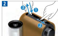
Berühren Sie eine Soft-Touch-Taste während Sie den Kapselfeinsatz schließen. Lassen Sie die Taste los, wenn das gewünschte Tasenfüllmenge erreicht wurde. Die beiden anderen Tasten blinken. Die Tasenfüllmenge wurde gespeichert. Sie können die gespeicherte Füllmenge in Zukunft immer mit der Soft-touch-Taste abrufen, die Sie zum Programmieren verwendet haben.
