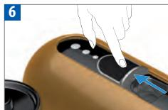
Allumez la machine en ouvrant la fenêtre coulissante en la poussant vers l'arrière de la machine. Voyant clignotant : chauffage pendant approx. 25 sec. Voyant allumé en continu : prêt.
