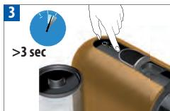
Para cambiar el modo de apagado automático de 9 a 30 minutos, compruebe que el deslizador está cerrado y, a continuación, mantenga pulsados los botones Lungo y Ristretto durante más de 3 s, al mismo tiempo que desplaza el deslizador hacia la parte trasera de la máquina hasta que se detenga. El botón Espresso se ilumina una vez. Para volver a la opción de 9 minutos repita el mismo procedimiento. El botón Espresso se ilumina tres veces.
