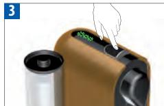
Zapněte přístroj posunutím posuvníku nebo dotykem na panelu. Tlačítko bliká: nahřívání přibližně 25 vteřin. Tlačítko svítí: přístroj připraven. Kapcsolja be a készüléket a csúszókapcsoló meghomárosával, vagy az érintőkapcsoló-térület megérintésével. Az egyik érintőkapcsoló villogása: felfűtés körülbelül 25 másodpercig. Folyamatos fény: készenlét.
