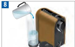
Füllen Sie den Wassertank wieder mit der aufgefangenen Entkalker-Lösung auf und wiederholen Sie den Vorgang, indem Sie eine der Soft-Touch-Tasten berühren.
