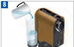
Naplňte nádobu na vodu použitým odvápněvacím roztokem a postup opakujte stiknutím libovolného tlačítka.
