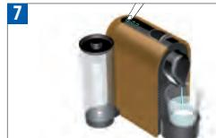
Wenn der Kapselfeinsatz geschlossen ist, berühren Sie eine der Soft-Touch-Tasten, um mit dem Entkalken zu beginnen. Sollte der Kapselfeinsatz geöffnet sein, schließen Sie ihn, um mit dem Entkalken zu beginnen. Das Gerät stoppt, wenn der Wassertank leer ist.
