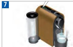
Si el deslizador está cerrado, pulse cualquier botón para iniciar la descalcificación. Si el deslizador está abierto, ciérrelo para iniciar la descalcificación. La máquina se detendrá cuando el depósito de agua esté vacío.
