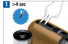
Appuyez et maintenez enfoncé le bouton Espresso pendant au moins 4 secondes, puis poussez la fenêtre coulissante vers l'arrière de la machine. Les deux autres boutons clignotent pour confirmation.
