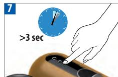
Přístroj lze kdykoliv vypnout (poloha OFF), je-li posuvník zavřený, podržením kteréhokoli z tlačítek po dobu minimálně 3 vteřin. Vypnutí potvrďte blíknutí zbylých dvou tlačítek.
