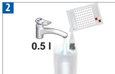
Do zbiornika na wodę wlać 1 jednostkę płynu odwapienia Nespresso i dodać 0,5 l wody.
