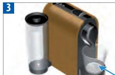
Umieścić pojemnik (minimalna pojemność: 0,6 l) pod otworem wylotu kawy.
