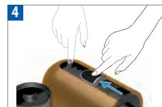
Schalten Sie das Gerät ein, indem Sie entweder den Schieber des Kapselinsatz bewegen oder eine der Soft-Touch-Tasten berühren.
