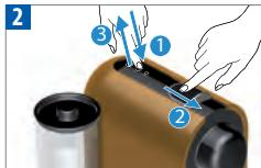
Mantenga pulsado el botón mientras cierra el deslizador. Suéltelo cuando haya alcanzado el volumen deseado. Los otros dos botones se iluminarán. El nivel del volumen de agua ha quedado registrado en el botón utilizado para la programación. Presione e mantenha pressionada a tecla enquanto fecha o deslizante. Solte a tecla quando atingido o volume desejado. As outras 2 teclas piscam. O volume de água está agora memorizado na tecla usada para a programação.
