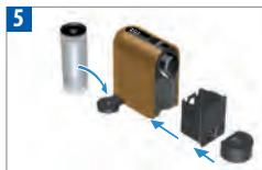
Umieścić ociekacz i pojemnik na zużyte kapsułki we właściwym miejscu. Dla twojego bezpieczeństwa, korzystaj z urządzenia tylko z właściwie umiejscowionym ociekaczem i pojemnikiem na kapsułki. Umieścić zbiornik na wodę na ramieniu. Zbiornik mocowany jest na magnesie.
