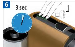
Pour entrer dans le mode détartrage, appuyez sur les 3 boutons en même temps pendant au moins 3 secondes. La machine émet un bip sonore pour confirmer l'opération. La zone de contrôle se met à clignoter.
