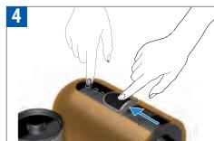
Démarrer la machine en déplaçant la fenêtre coulissante ou en appuyant sur un bouton de sélection.
