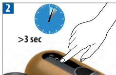
Sie können das Gerät jederzeit ausschalten, indem Sie eine beliebige Soft-Touch-Taste mind. 3 Sekunden lang berühren. Hierzu muss der Schlitten geschlossen sein. Zur Bestätigung blinken die beiden anderen Tasten.
