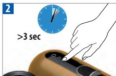
Přístroj je možné kdykoli vypnout, je-li posuvník zavřený, přidržením kteréhokoli tlačítka po dobu 3 vteřin. Vypnutí potvrď bliknutí zbylých dvou tlačítek.
