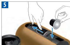
Öffnen Sie den Schieber des Kapseleinsatzes vollständig und legen Sie eine Nespresso Kapsel ein.
