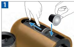
Każdy z przycisków można zaprogramować. Otworzyć zasuwę. Naciśnąć i przytrzymać przycisk, zamkając zasuwę. Zwolnić przycisk po uzyskaniu pożądanej ilości. Otworzyć zasuwę do końca i włożyć kapsułkę Nespresso.
