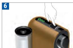
Sie können das Gerät jederzeit ausschalten, indem Sie eine beliebige Soft-Touch-Taste mind. 3 Sekunden lang berühren. Hierzu muss der Schlitzen geschlossen sein. Zur Bestätigung blinken die beiden anderen Tasten.
