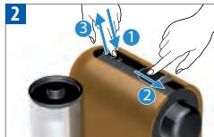
Všechna tlačítka jsou programovatelná. Otevřete posuvník. Stiskněte a držte tlačítko a zároveň zavírejte posuvník. Otevřete úplně posuvník a vložte kapsli.
