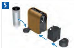
Umístěte nádobu na vodu na rameno, které je uchcenou magnety. Zasuňte odkapávací mřížku a kontejner na použité kapsle na správné místo. Pro vaši bezpečnost, používejte přístroj jen se správně umístěnou odkapávací miskou a kontejnerem na použité kapsle.
