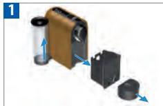
Αφαιρέστε το δοχείο νερού και το δοχείο καψουλών. Ρυθμίστε το μήκος του καλωδίου, χρησιμοποιώντας τον χρόνο αποθήκευσης του καλωδίου που βρίσκεται κάτω από τη μηχανή. Verwijder het waterreservoir en het capsuleservoir Stel de snoerlengte af en berg het overtollige snoer onder de machine op.
