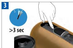
Pro změnu nastavení automatického vypnání na 9 na 30 minut zavřete posuvník a stiskněte tlačítka Lungo a Ristretto na minimálně 3 vteřiny. Tlačítka Espresso jednou blikně. Pro návrat do původního nastavení na 9 minut postup opakujte, tlačítka Espresso blikně třikrát.
