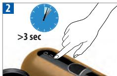
La machine peut être mise en mode Arrêt à tout moment quand la fenêtre coulissante est fermée en maintenant appuyé un contrôle tactile pendant plus de 3 sec, confirmée par les 2 autres boutons clignotants.
