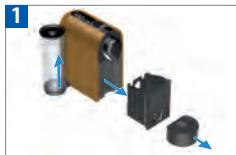
Entnehmen Sie den Wassertank und den Kapselbehälter. Stellen Sie die Kabellänge ein und verstauen Sie den überlangen Teil des Kabels unter dem Gerät.
