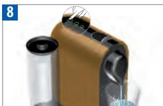
Coloque un recipiente debajo de la salida de café. Pulse el botón Lungo. Cierre el deslizador para aclarar la máquina. Repita tres veces.
