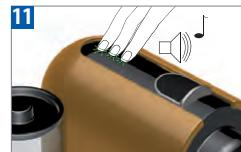
Pour quitter le mode détartrage, appuez sur les 3 boutons en même temps pendant au moins 3 secondes. La machine émet un bip sonore pour confirmer l'opération. La machine est maintenant prête à l'emploi.
