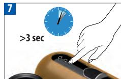
Ekspres można w każdej chwili wyłączyć, naciskając i przytrzymując dowolny przycisk przez dłużej niż 3 sekundy przy zamkniętej zasuwie. Wykonanie czynności potwierdza pulsującą diodą pozostały dwie przyciski.
