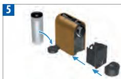
Plazieren Sie den Wassertank auf dem Wassertankarm. Dort wird er von Magneten gehalten. Setzen Sie die Tropfschale und den Kapselbehälter in die richtige Position ein. Zu Ihrer eigenen Sicherheit nutzen Sie die Maschine nur mit eingesetzter Tropfschale und Kapselbehälter.
