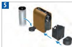
Coloque el depósito de agua en su brazo. Queda fijado con imanes. Introduzca la bandeja antigoteo y el contenedor de cápsulas usadas en su posición. Para su seguridad, utilice la máquina sólo cuando la bandeja antigoteo y el contenedor de cápsulas usadas estén en su posición.
