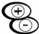
Le thermostat du spa fournit un contrôle optimum de la température de l'eau. Le réglage peut être ajusté dans une plage allant de 18 °C à 40 °C (65 °F à 104 °F). Pour élever la température, presser le bouton + et pour la diminuer, presser le bouton -. *Remarque : dès que vous appuyez sur le bouton de réglage, la température en cours s'affiche.*
