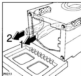
Enlever le bloc de polystyrène du fond de la machine; il n'est pas nécessaire de le conserver. Dégager les deux sachets en polyéthylène en enlevant l'adhésif.
