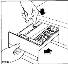
Les détergents et l'assouplissant s'incruster à la longue. Nettoyer de temps en temps le tiroir bacs à produits sous un jet d'eau. A cette fin il est possible d'extraire complètement le tiroir de la machine en appuyant sur l'arrêt au fond à gauche.
