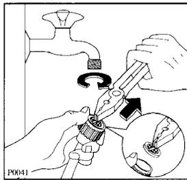
Si l'on remarque que la machine prend plus de temps à se remplir, il est conseillé de contrôler que le filtre du tuyau d'arrivée d'eau ne soit pas bouché. Fermer le robinet de l'eau. Dévisser l'embout du tuyau du robinet. Extraire le filtre de son logement,
