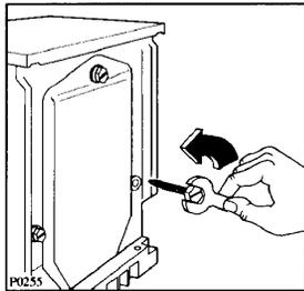
Dévisser à l'aide d'une clé la vis arrière droite. Coucher l'appareil sur le dos, en faisant attention à ne pas endommager les tuyaux. A cet effet placer une cornière de l'emballage entre la machine et le sol.
