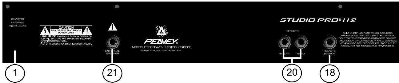
des externen, Low-Level-Effektgerätes. Legen Sie das Return-Signal von Ihrem externen Gerät zu der RETURN-Buchse Ihres Verstärkers. Diese Verbindung nennt sich Einschleifweg für Effekte, da ein Signal von Ihrem Verstärker ausgeht (Send) und wieder zurück (Return) eingeschleift wird. Mit dem Modell Bandit 112 können Sie die Effekt-Einschleifung mit dem Fußschalter (18) aktivieren/deaktivieren.
