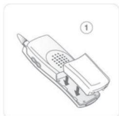
Positionner la batterie dans la glissière en suivant le repère indiqué sur l'étiquette
