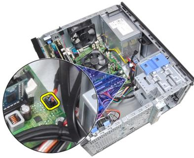
6. Retirez le câble du commutateur électrique des clips du châssis.
