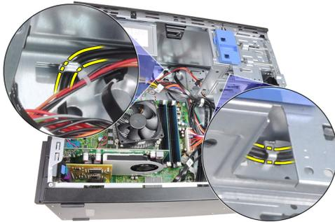
7. Retirez le câble du commutateur électrique du clip du châssis.
