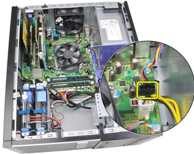
4. Retirez le ventilateur du système des quatre rondelles de fixation à l'arrière de l'ordinateur.
