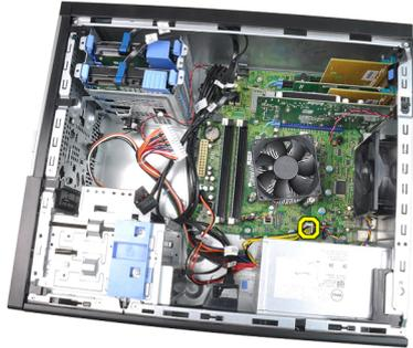
7. Retirez les vis de fixation du bloc d'alimentation électrique à l'arrière de l'ordinateur.
