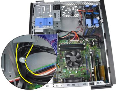
6. Retirez la vis de fixation du panneau d'entrée/sortie à l'ordinateur.
