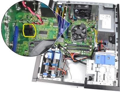
4. Faites glisser le commutateur d'intrusion vers l'arrière du châssis et retirez-le de la carte système.
