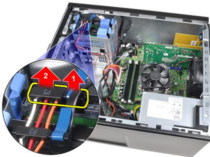
4. Appuyez sur les deux languettes bleues de support de fixation et sortez le support du disque dur de la baie en le soulevant.
