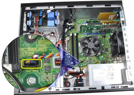
4. Desserrez les vis captives de fixation du dissipateur de chaleur à la carte système.
