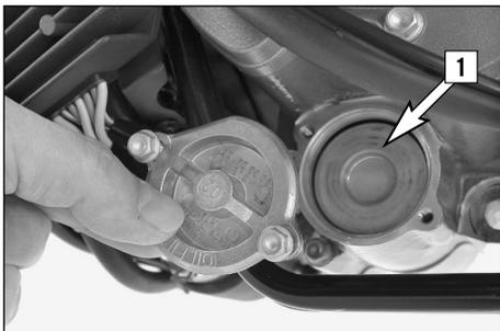
Enfiler un filtre à huile neuf [1] dans le carter. Graisser le joint torique et monter le couvercle avec le joint. Serrer les vis à 6 Nm.
