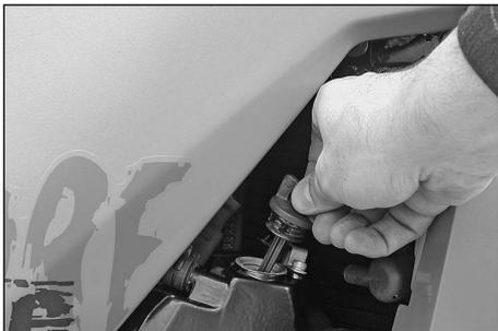
Remplir avec 2,5 litres d'huile de synthèse selon la norme JASO MA (par ex. Motorex Power Synt 4T) et mettre la jauge à huile. Faire démarrer le moteur, le laisser chauffer 4 minutes puis le couper. Retirer la jauge et rajouter de l'huile jusqu'au repère MAX (environ 0,5 litre).
