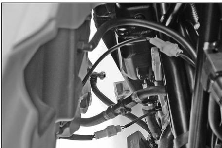
Mettre le cache de la batterie et serrer les vis à 25 Nm. Mettre la vis du bas du réservoir droit et la serrer à 25 Nm.
