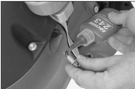
Mettre de la loctite 243 sur les 4 vis qui tiennent le sabot. Les serrer à 25 Nm.
