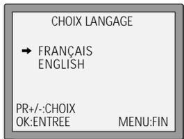
Affichez MENU PRINCIPAL du magnétoscope et sélectionnez « Réglage Magnétoscope », puis « Choix Langage ».
