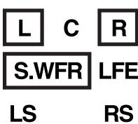
Bsp. Es wird kein Klang über den Mittenlautsprecher und die Surround-Lautsprecher ausgegeben, obwohl Signale des Mittenlautsprecher- und Surroundkanals in den Receiver eingehen.
