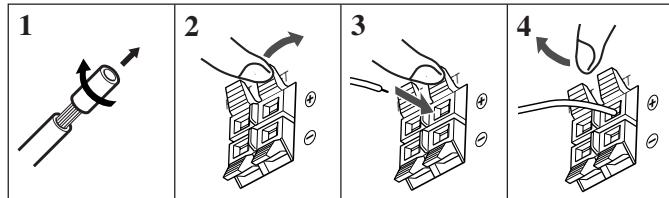
Verbinden Sie bei jedem Lautsprecher (mit Ausnahme des Subwoofers) die Klemmen (+) und (-) auf der Rückseite des Receivers mit den Klemmen (+) und (-), die an den Lautsprechern gekennzeichnet sind.
