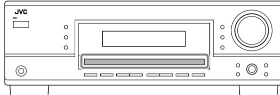
Drücken Sie eine der Tasten zum Auswählen der Signalquelle.
