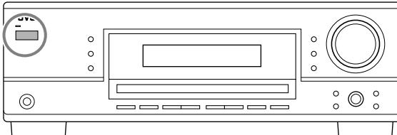
Appuyez sur STANDBY/ON ⏻ (ou STANDBY/ON ⏻/AUDIO sur la télécommande).
