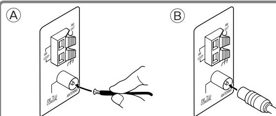
De FM-antenne dient horizontaal te worden bevestigd.
