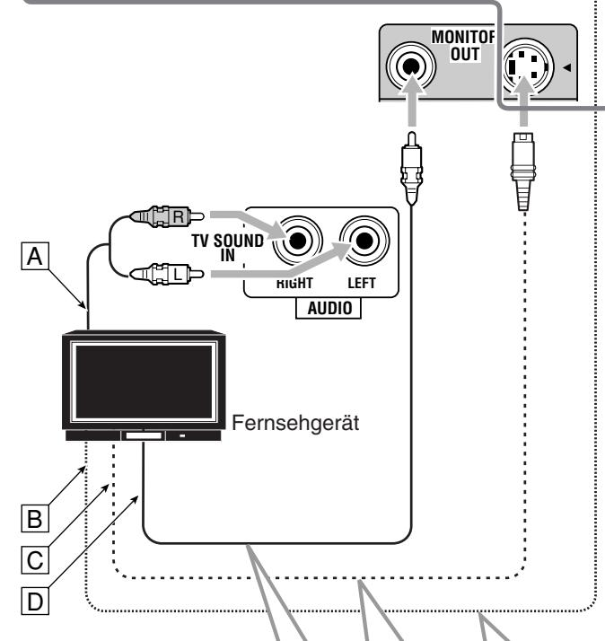
*Schließen Sie das Fernsehgerät an die dafür vorgesehenen Buchsen MONITOR OUT an, um das Wiedergabebild der angeschlossenen Video-Komponenten zu sehen.*
