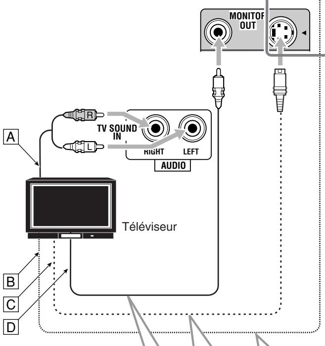
Connectez le téléviseur aux prises MONITOR OUT appropriées permettant de voir l'image de lecture de n'importe quel autre appareil vidéo connecté.
