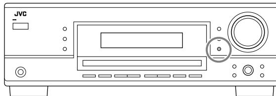
Drücken Sie die Taste INPUT ATT (INPUT ANALOG), und halten Sie sie gedrückt, so daß sich die INPUT ATT-Anzeige leuchtet im Display auf.
