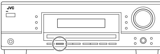
**Druk op de toets SUBWOOFER OUT ON/OFF om de weergave via de subwoofer uit te schakelen.**
