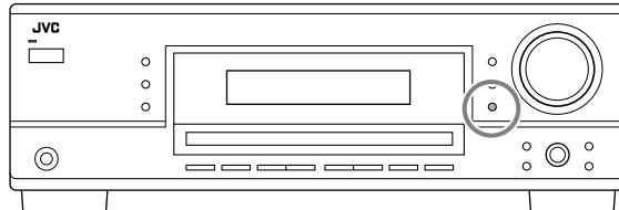
Druk op de toets INPUT ATT (INPUT ANALOG) en houdt deze ingedrukt zodat de indicator INPUT ATT op de display oplicht.
