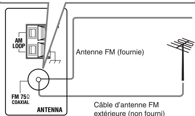
Connecter l'antenne FM fournie de façon temporaire à la prise FM 75 Ω COAXIAL—Ⓐ
