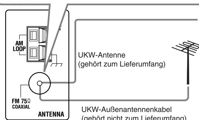
Verbinden Sie die mitgelieferte UKW-Antenne für vorübergehenden Einsatz mit dem FM  $75\Omega$  COAXIAL Anschluß—Ⓐ
