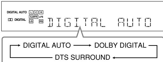
Wenn „DOLBY DIGITAL“ oder „DTS SURROUND“ ausgewählt wird, erlischt die DIGITAL AUTO-Anzeige und die entsprechende Anzeige für das digitale Signalformat leuchtet auf dem Display auf.
