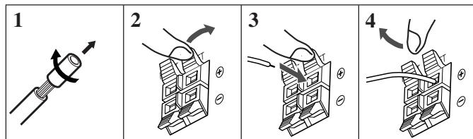
Sluit voor alle luidsprekers (behalve de subwoofer) het ene uiteinde van een luidsprekerkabel aan op de aansluitpunten (+) en (-) op de achterzijde van de ontvanger en het andere uiteinde op de aansluitpunten (+) en (-) van de luidsprekers.
