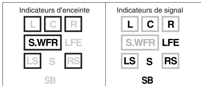
**Quel indicateur d'enceinte s'allume dépend du réglage des enceintes (pour les détails, référez-vous à "Réglage des enceintes" à la page 23).**
