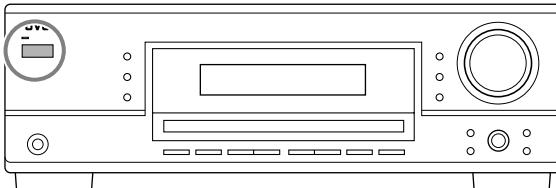
Drücken Sie die Taste STANDBY/ON  $\odot/\|$  (oder STANDBY/ON  $\odot/\|$  AUDIO auf der Fernbedienung).
