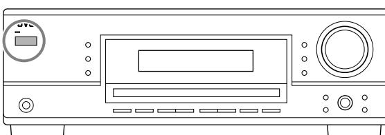
Druk op de toets STANDBY/ON  $\odot/\text{I}$  (of STANDBY/ON  $\odot/\text{I}$  AUDIO van de afstandsbediening).
