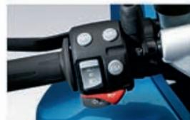
Quel que soit le réglage choisi, avec la **suspension à réglage électronique ESA**, vous trouvez toujours l'amortissement optimal en appuyant simplement sur un bouton.
