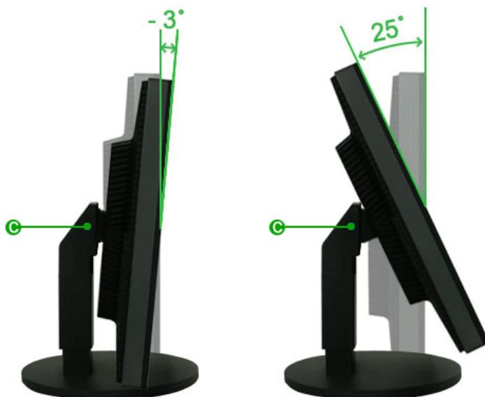
※ (C), permet de régler l'angle d'inclinaison de 3° à 25° vers l'arrière pour obtenir l'angle de vision le plus confortable.
