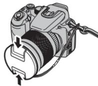
Pour éviter de perdre le capuchon d'objectif, passez le cordon fourni à travers l'œillet et fixez le capuchon d'objectif à la dragonne.
