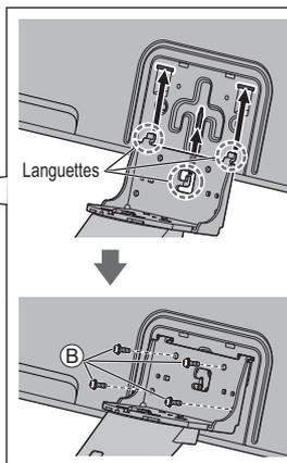
Alignez les 3 languettes de l'applique avec les rainures au dos du téléviseur et insérez-les y.
