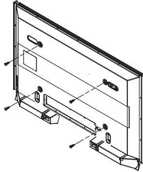
2 Installez les pièces isolantes sur les vis (voir l'illustration ci-dessous).
