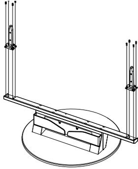
2 Fixez solidement le moniteur sur les tenons au moyen des 4 vis fournies.
