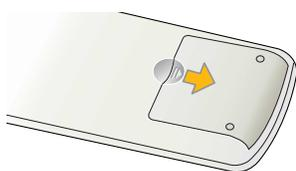
**2** Insérez deux piles AAA. Veillez à ce que les bornes + et - des piles correspondent à celles du schéma qui figure à l'intérieur du compartiment.
