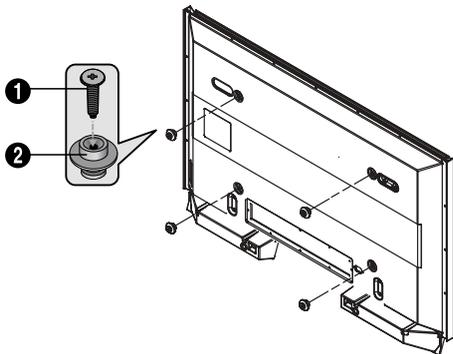
4 Insérez les 4 pièces isolantes de l'écran dans les rainures du support de fixation murale et abaissez l'écran (1) pour le fixer sur le support (2). Serrez la vis de la façon indiquée (3) afin que l'écran ne puisse se détacher de son support.
