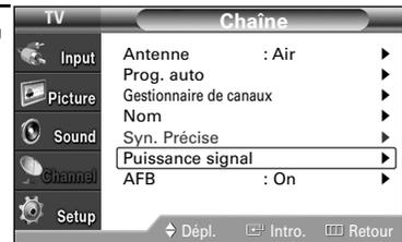
Si l'indicateur de puissance indique que le signal numérique est faible, déplacez votre antenne de manière à augmenter la puissance du signal. Continuez à régler l'antenne jusqu'à obtenir un signal maximum.
