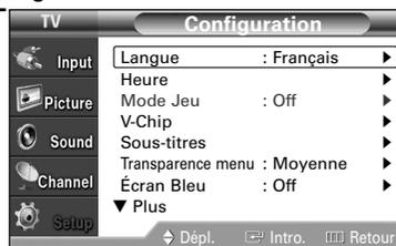
2 Appuyez sur le bouton ▲ ou ▼ pour sélectionner "Heure", puis appuyez sur le bouton ENTER. Appuyez sur le bouton ENTER pour sélectionner "Horloge".
