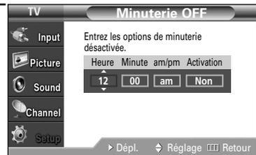
Pour activer la Minuterie OFF avec le réglage entré, mettez Activation à "Oui" en appuyant sur le bouton ▲ ou ▼.
