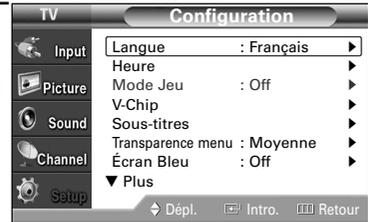
2 Appuyez sur le bouton ▲ ou ▼ pour sélectionner "Heure", puis appuyez sur le bouton ENTER. Appuyez sur le bouton ▲ ou ▼ pour sélectionner "Mise en veille", puis appuyez sur le bouton ENTER.
