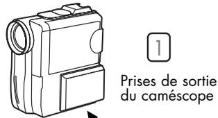
2 Au moyen d'un jeu de câbles audio, reliez les prises d'entrée AUDIO IN du téléviseur et les prises de sortie AUDIO du caméscope. Si votre caméscope est monophonique, branchez L (mono) à la sortie audio du caméscope au moyen d'un seul câble audio.
