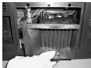
4 À l'aide d'un tournevis, retirez la vis maintenant la lampe.
