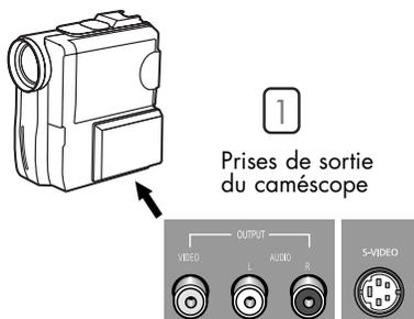
2 Reliez, au moyen d'un câble vidéo, la prise d'entrée VIDEO IN (ou S-VIDEO IN) du téléviseur et la prise de sortie VIDEO OUT du caméscope.
