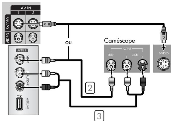
3 Au moyen d'un jeu de câbles audio, reliez les prises d'entrée AUDIO IN du téléviseur et les prises de sortie AUDIO du caméscope. Si votre caméscope est monophonique, branchez L (mono) à la sortie audio du caméscope au moyen d'un seul câble audio.
