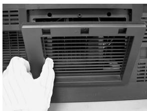
3 Retirez le conduit de ventilation de l'écran protecteur de la lampe maintenant le dispositif de fermeture.
