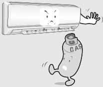
► N'installez pas l'unité dans un endroit où il y a une fuite de gaz inflammable. Cela risque de provoquer une explosion.
