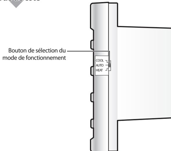
**Note** ♦ Choisissez le mode de fonctionnement approprié entre le mode Cool (réfrigération) / Auto / Heat (chauffage) en utilisant le bouton de sélection du mode de fonctionnement.
